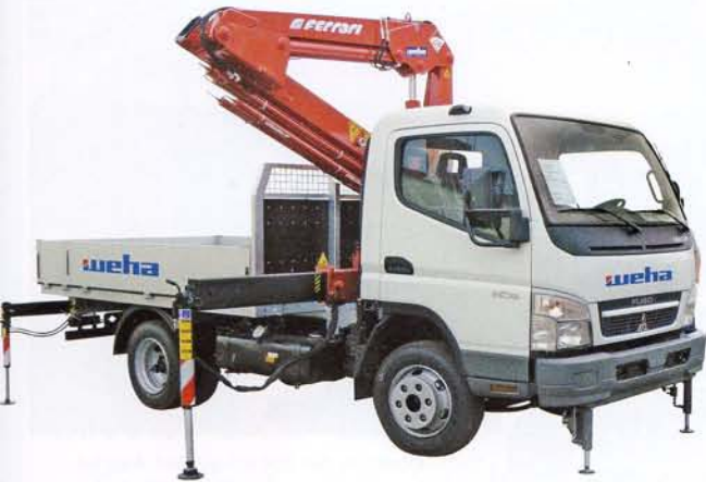
Premiere auf der Hausmesse: LKW mit 6-facher Abstützung für den Kranbetrieb in un- ebenem und schrägem Gelände
